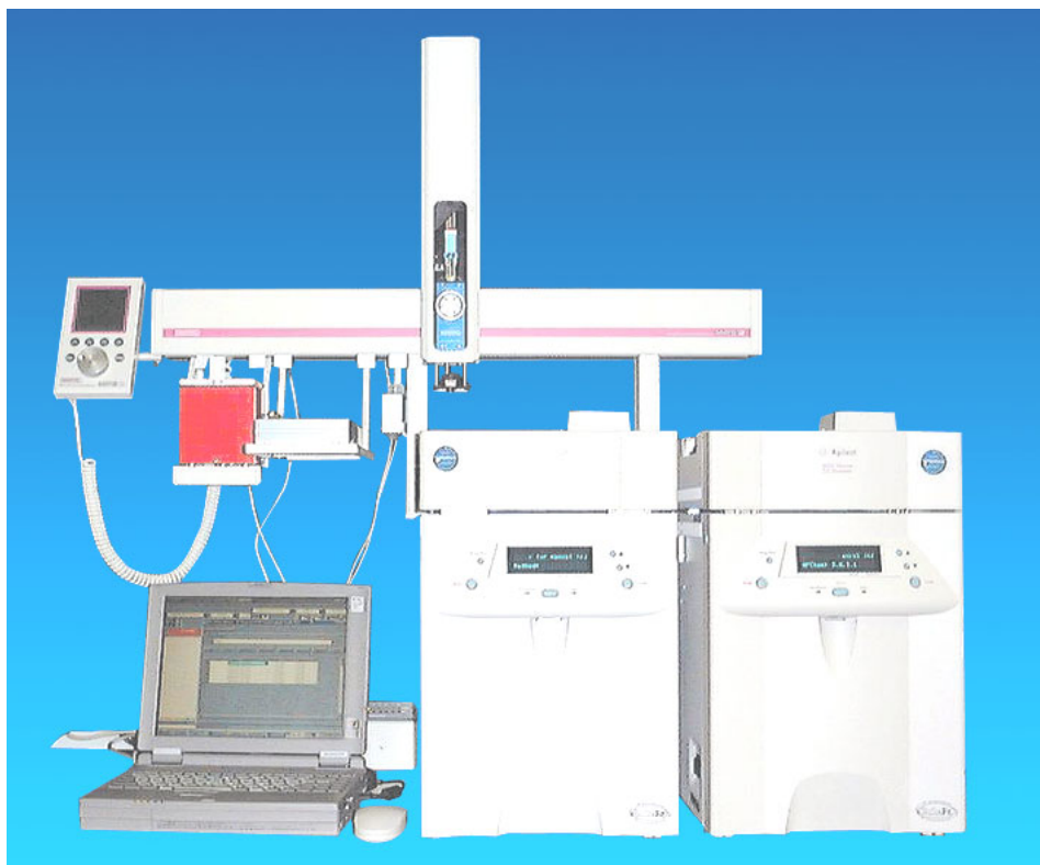
Bild 3.3-1 Analysutrustning av typ FID för bestämning av bl a halt PAH i extrakt. (Foto: Impressed AB)
