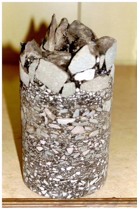
Bild 3.1-2 Borrhärlar med stenkollstjärna.
