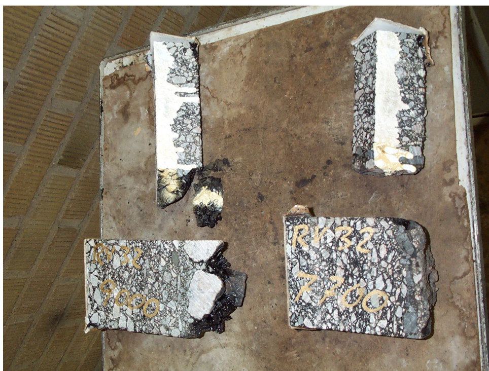
Bild 3.2-1 Sågade och neddelade provkroppar före beredning av extrakt.
