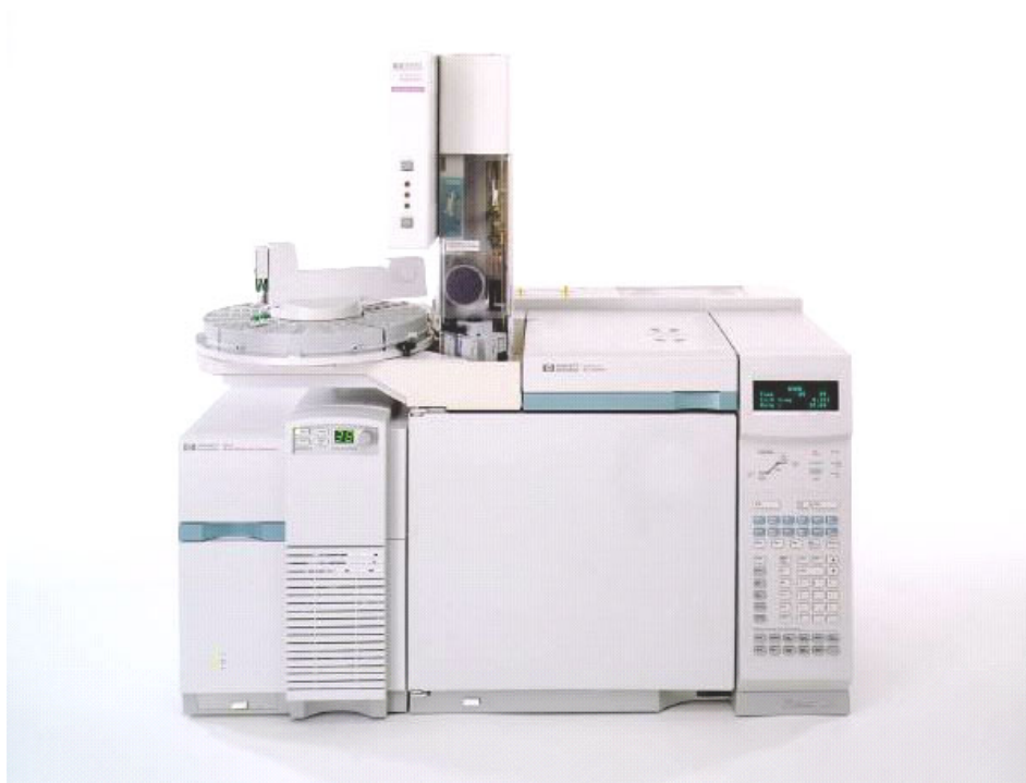
Bild 3.3-2 Analysutrustning av typ MS för bestämning av bl a halt PAH i extrakt. (Foto: Impressed AB)
